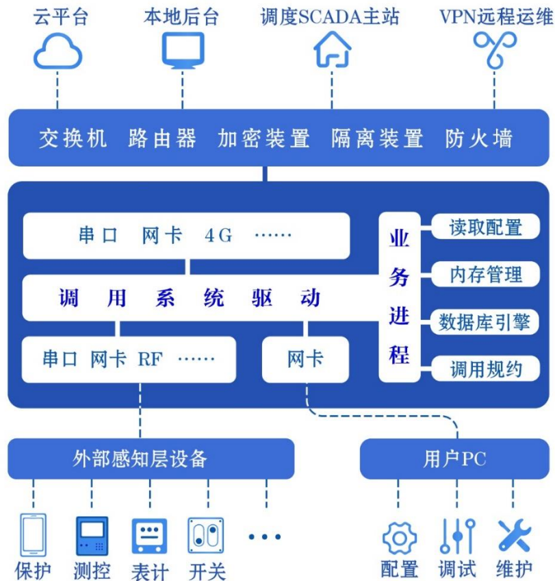
图 2-2 通讯管理机工作原理图
