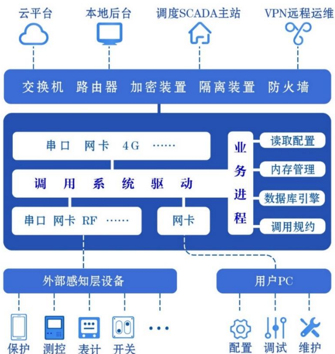
图 1-2 通讯管理机工作原理图
