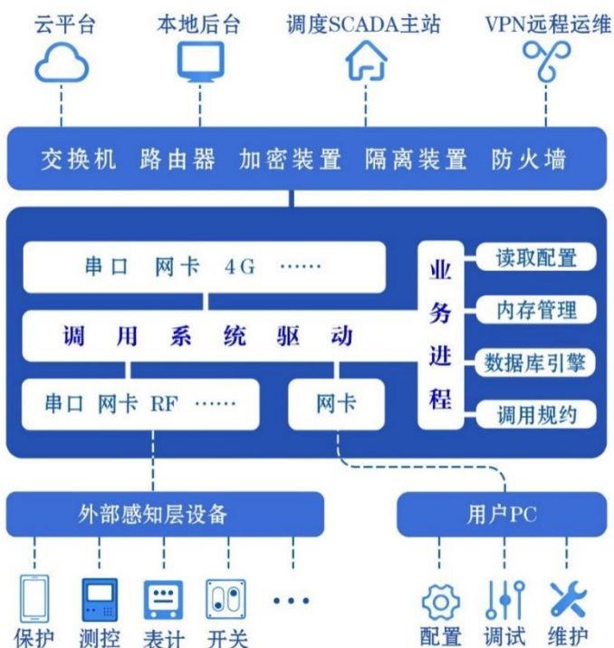
图 1-2 通讯管理机工作原理图
