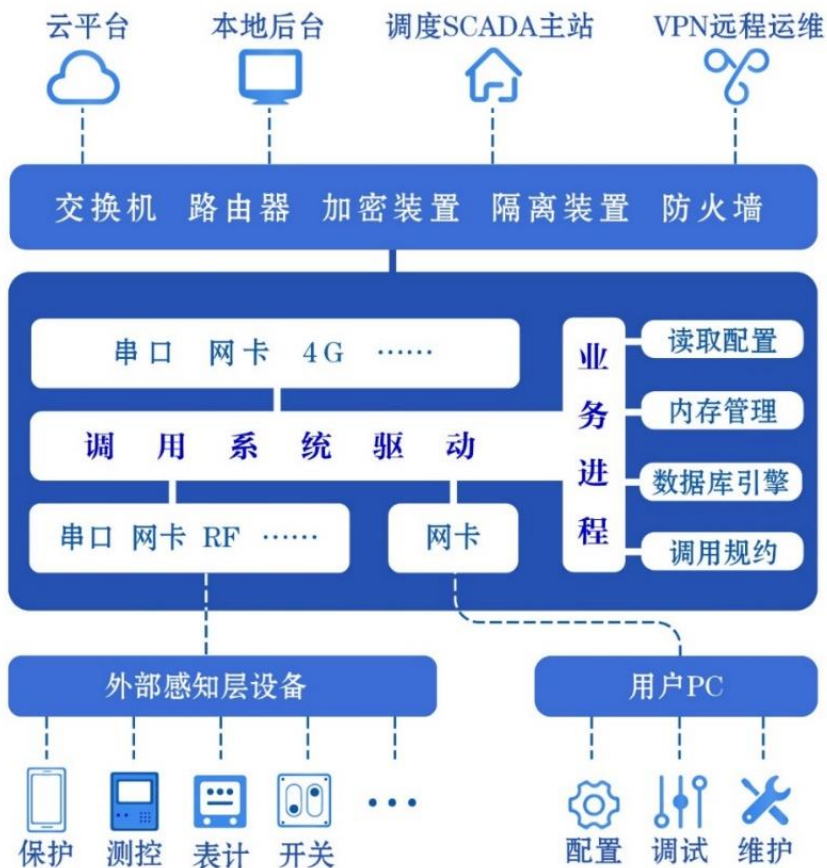
图 1-2 通讯管理机工作原理图
