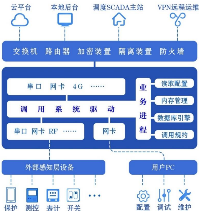
图 1-3 通讯管理机工作原理图
