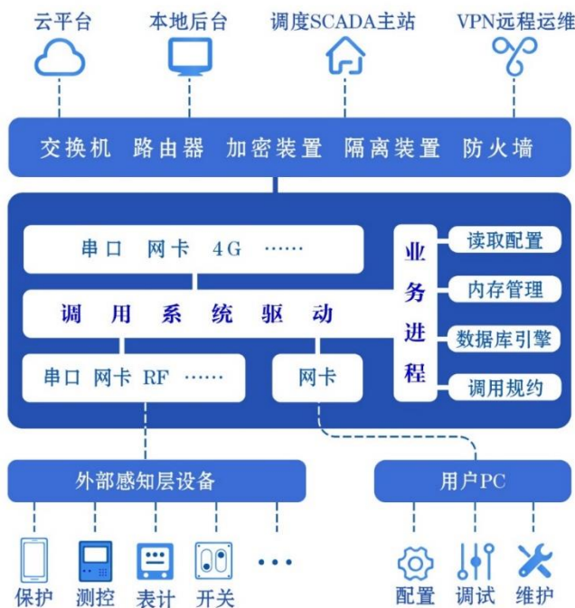
图 1-3 通讯管理机工作原理图
