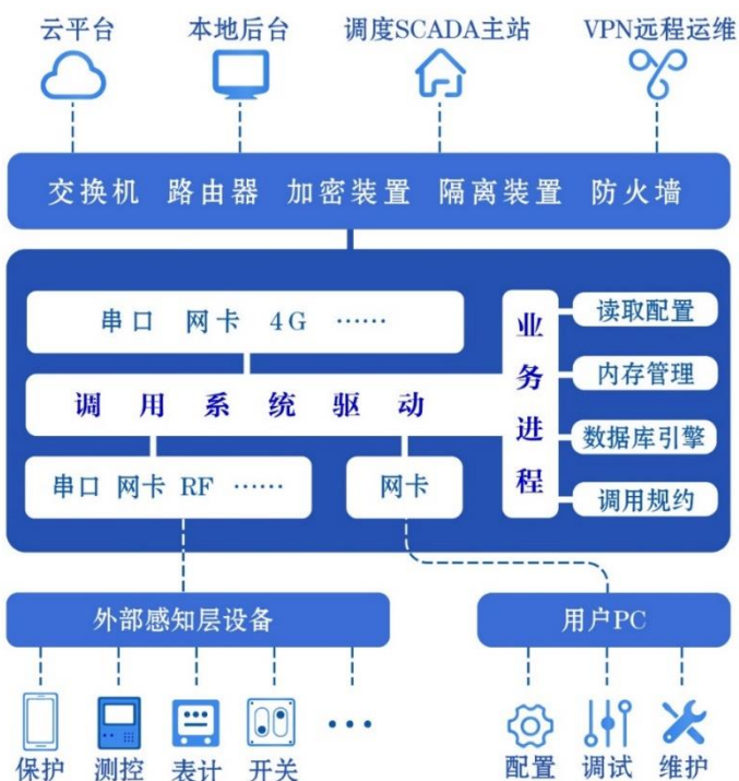
图 1-3 通讯管理机工作原理图
