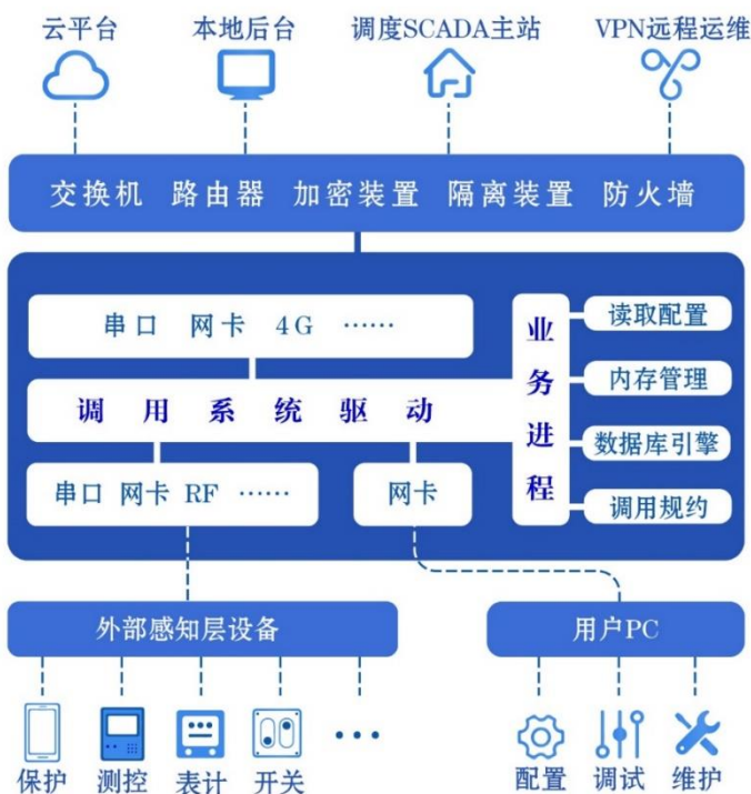
图 1-3 通讯管理机工作原理图
