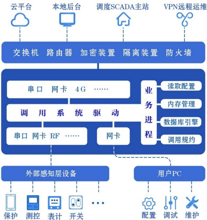
图 1-3 通讯管理机工作原理图
